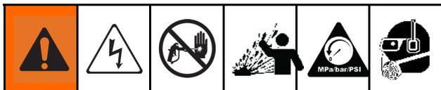
感電を避けるため、システムをシャットダウンします。すべての電気配線は資格を有する電気技師が行う必要があります。ご使用の地域におけるすべての法令に従ってください。皮膚の貫通などの加圧状態の液体、液体の飛散、および可動部品から生じる重大な怪我を避けるには、スプレー停止後と装置を清掃、点検、および整備する前に、圧力開放の順序に従ってください。
