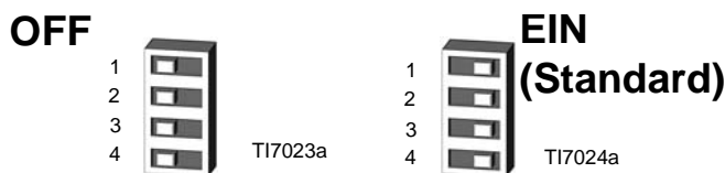
ABB. 7. Einstellungen des DIP-Schalters (SW2)
